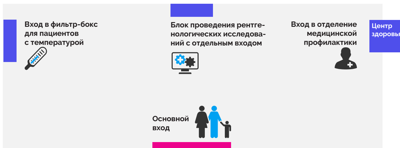
Рисунок 3. Отдельные входы в здание поликлиники с улицы
